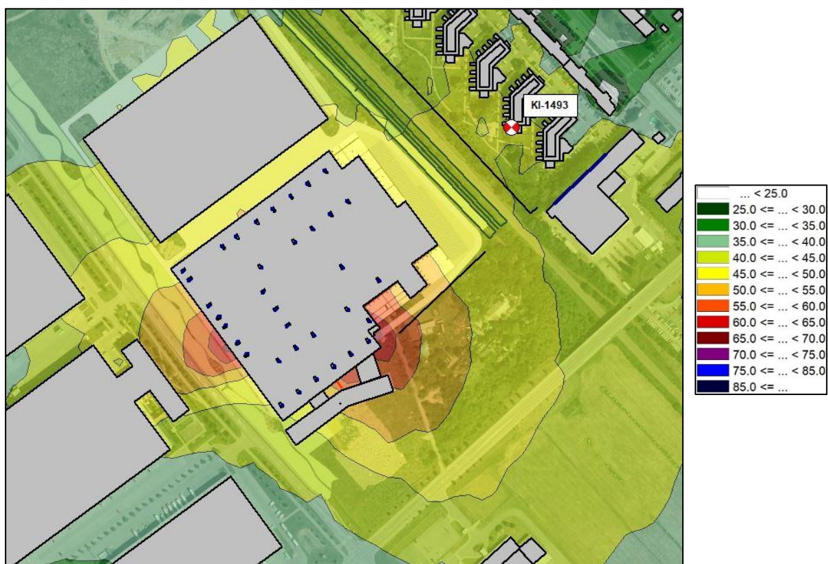
Obr. Provoz jednotek rooftop v noční době – skutečný stav – výška izofon 15 m
